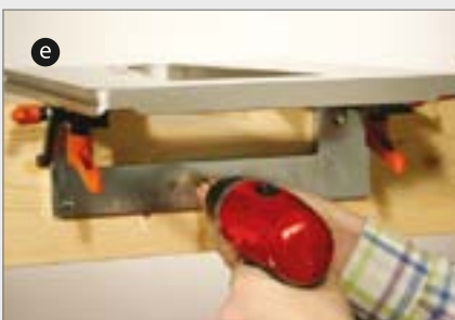
Upevnite šablónu na nosník pomocou upínadla, alebo priskrutkovaním
