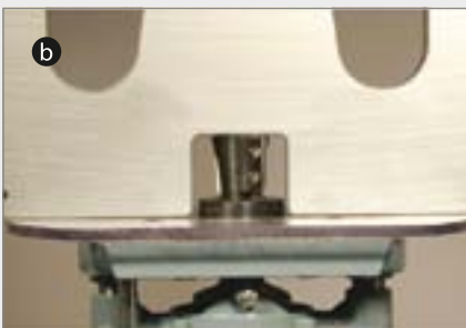
Hĺbku frézovania možno regulovať pomocou kalibra
