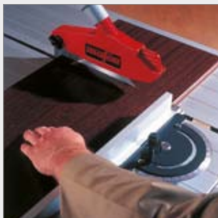
Presná a bez otrepov: tu je znázornený identikit píly s pod pultom sa pohybujúcim listom ERIKA 70 EC.
