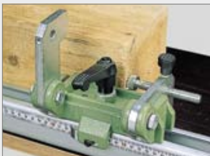
Zarážkový profil s dĺžkou 3 m pozdĺžne zarážky umožňujú presné umiestnenie do správnej polohy.
