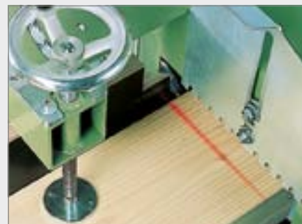
Nová laserová technológia po predkreslení umožňuje umiestnenie dielu do správnej polohy.
