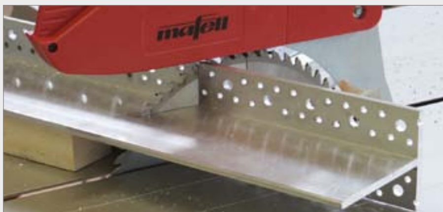
Presná a bez otrepov: tu je znázornený identikit píly s pod pultom sa pohybujúcim listom ERIKA 70 EC.
